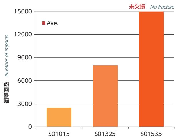
刃先処理が大きくなる程、耐欠損性能が向上。
