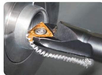
F1 chipbreakers evacuate chips BACKWARD (S-STUC style shown)
