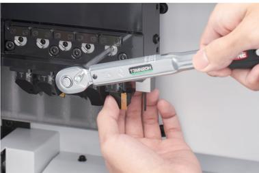
独自のカップリング構造により、ツールの着脱時はレンチを半回転締め込むだけの、クイックツールチェンジを実現。
