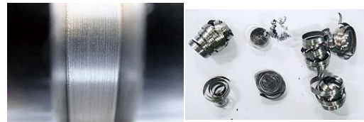
図. SCM415 溝入れ加工時の加工面と切屑
