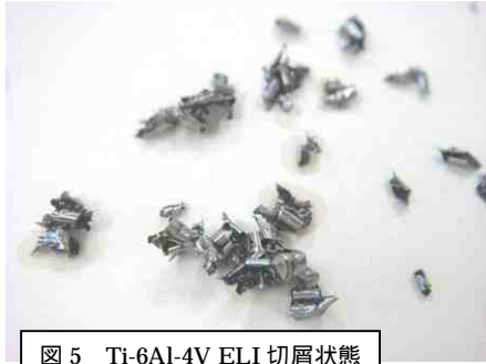
図 5 Ti-6Al-4V ELI 切屑状態
