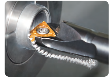
F1-Spanbrecher ermöglicht rückwärtige Spanabfuhr
